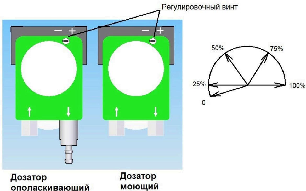
**ВНИМАНИЕ!** Изменение положения регулировочного винта на корпусе дозатора (заводская настройка - винт выкручен «в плюс» до упора у обоих дозаторов) может привести к снижению качества мойки.
